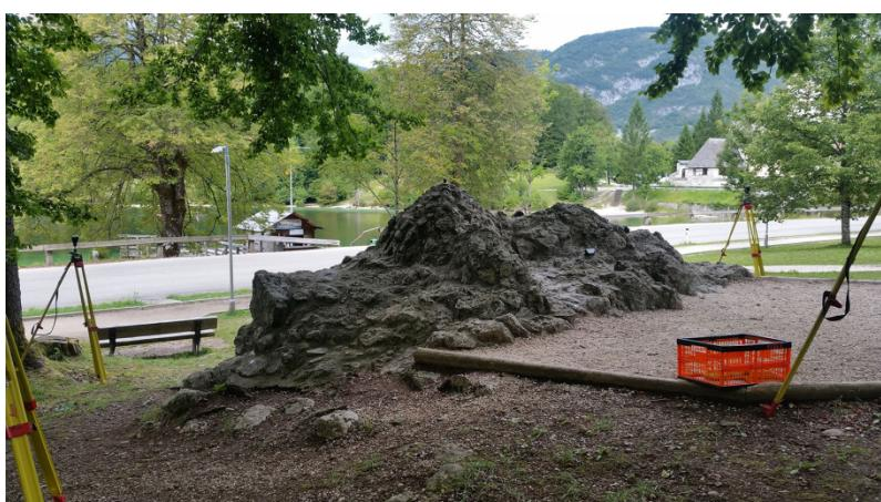
**Fig. 3** Stone model of Mount Triglav at the time of survey (by Anita Anželak); marker for reference points; geodetic network around the model.**Slika 3.** Maketa Triglava za vrijeme izmjere (fotografija Anita Anželak); signalizacija referentnih točaka; geodetska mreža izmjere točaka.
