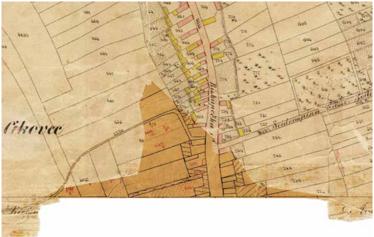
Figure 10. Visible discrepancies between map A and the inserted triangular section from map B Slika 10. Vidljivo nepoklapanje linija na karti A i uklopljenog dijela plana B pomakom i zakretom
