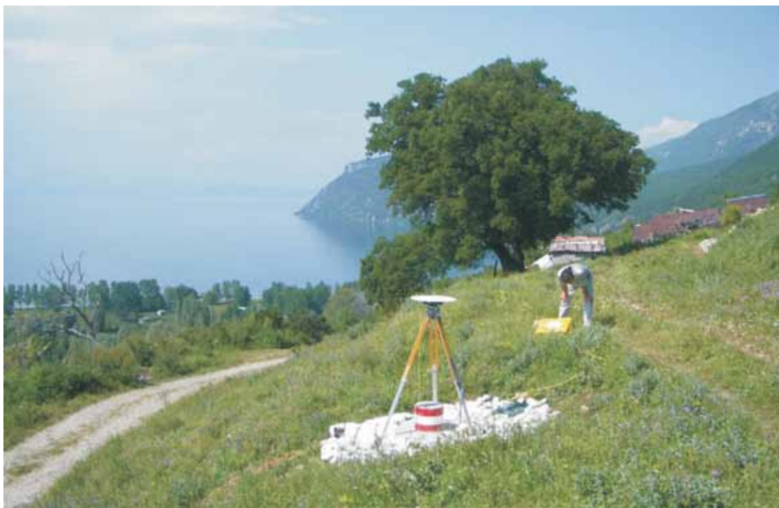
Fig. 2. GPS surveys of orientation points Slika 2. Izmjera orijentacijskih točaka GPS-om
