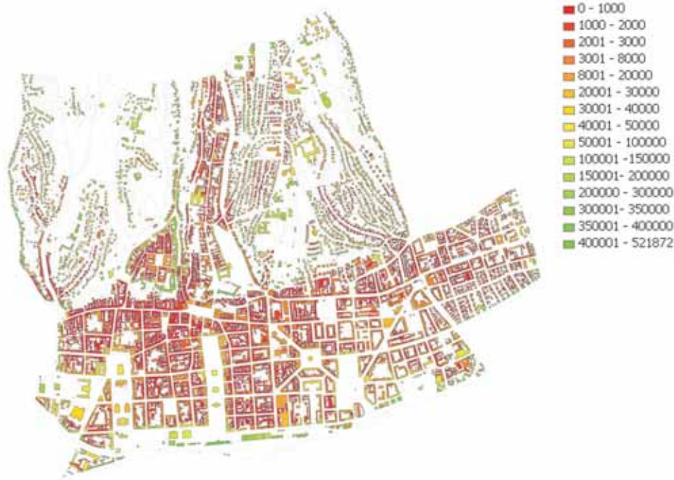
Fig. 9. Thematic display of the visibility area [m 2 ] for the whole test area Slika 9. Tematski prikaz površine vidljivosti [m 2 ] za cijelo testno područje
